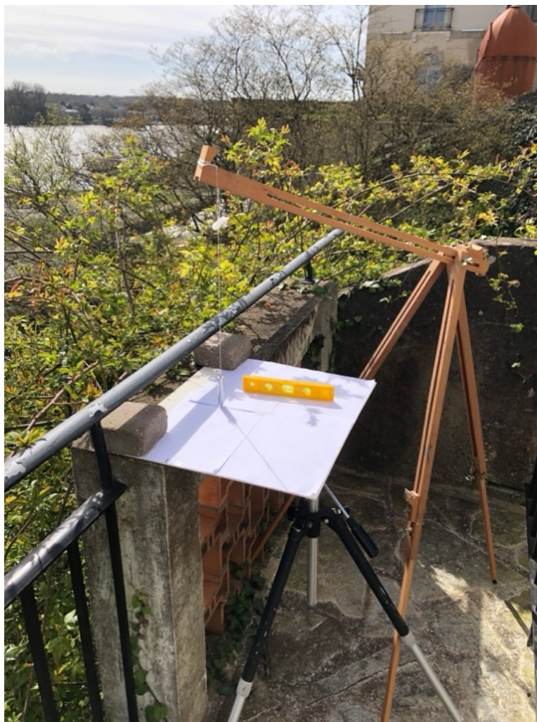
Fig. 17 : Dispositif qui m'a permis de déterminer précisément l'orientation du méridien local par rapport au mur support : sur une surface horizontale, on marque l'ombre d'un fil à plomb à midi solaire vrai. La différence avec l'orientation inscrite dans la rose des vents est exactement de 10,0^\circ . Le fait que
