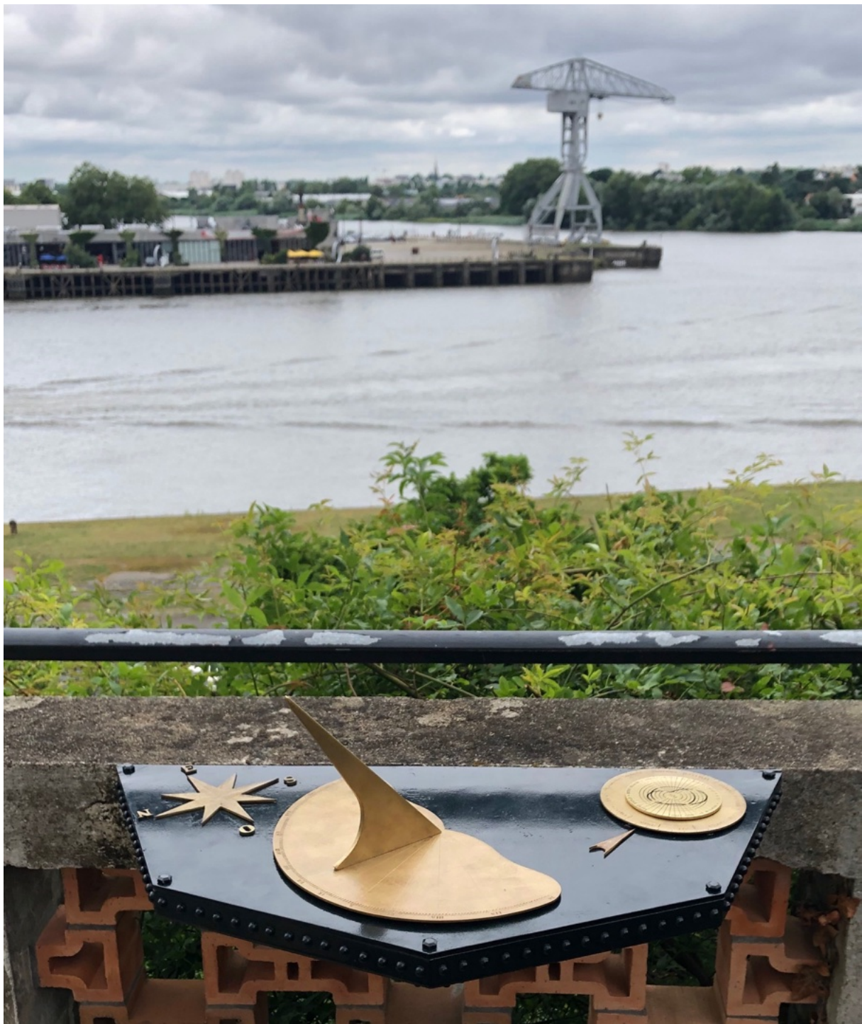
Fig. 20 et 21 : L'ensemble gnomonique réhabilité. On notera que le style n'est pas aussi biseauté que souhaitable, mais il a évidemment été tenu compte, par les services techniques, de considérations non scientifiques, notamment dans le domaine de la sécurité des visiteurs.
