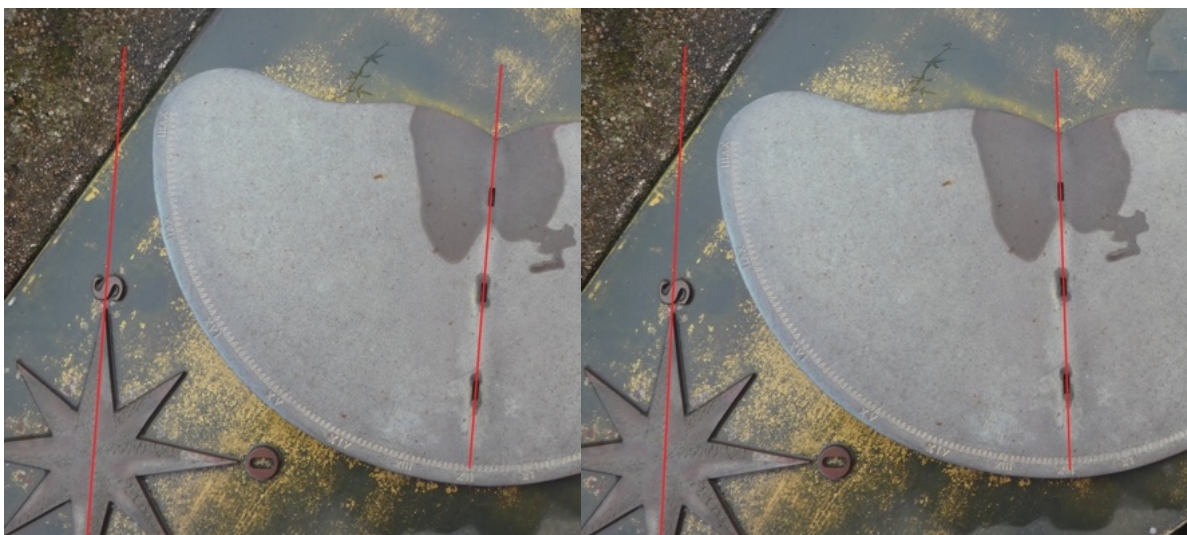
Fig. 12 : les deux positions extrêmes du mouvement d'oscillation horizontale du cadran (à gauche la ligne de midi est parallèle au méridien de la Rose des vents, à droite elle est décalée d'environ 4,5° vers l'Ouest)
